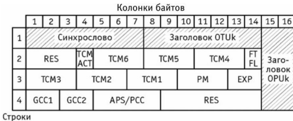
Рисунок 2.6 – Структура заголовка ODUk
