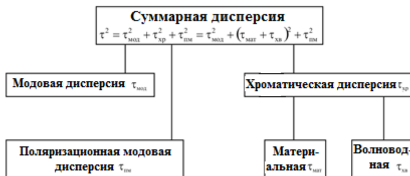
Рисунок 3.9 – Виды дисперсии в ОВ
