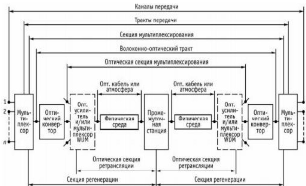
Рисунок 1.2 – Обобщенная схема оптической системы передачи
