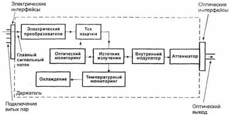
Рисунок 2.4 – Складові елементи передавального оптикоелектронного модуля
