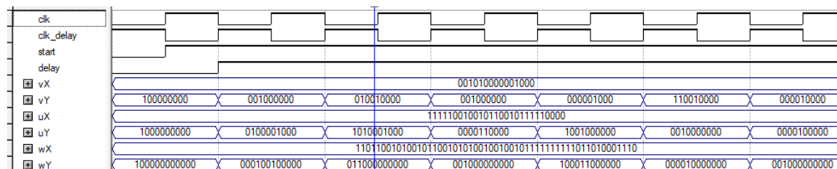
Рисунок 4.52 – Часові діаграми паралельної схеми структур з вбудованою пам'яттю
