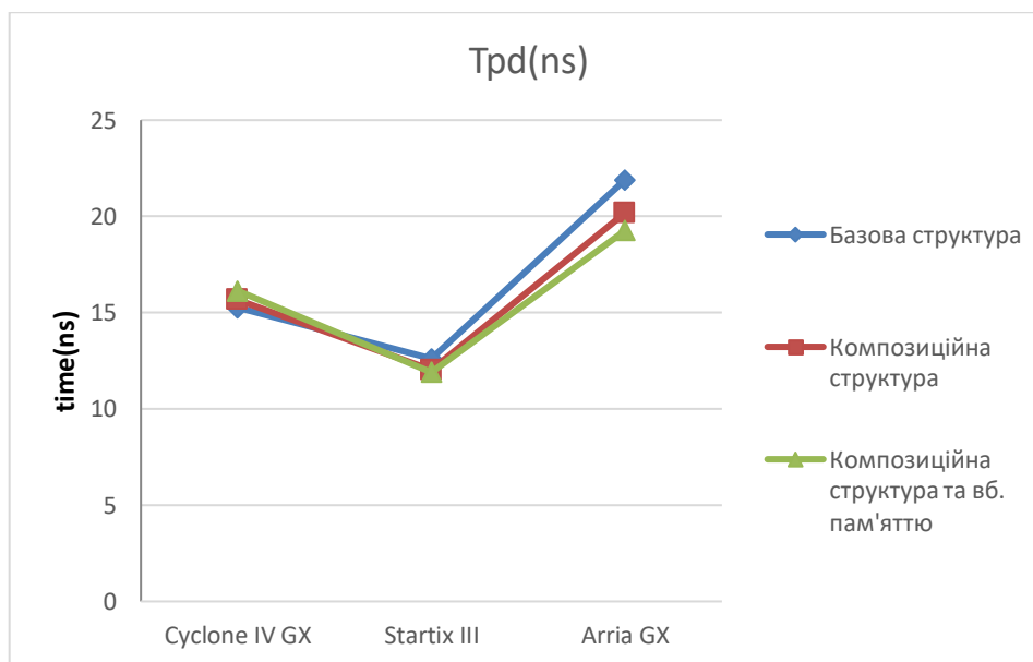
Рисунок 4.32 – Затримка t_{pd} при тестуванні різних структур автомату який працює за третьою ГСА на різних мікросхемах
