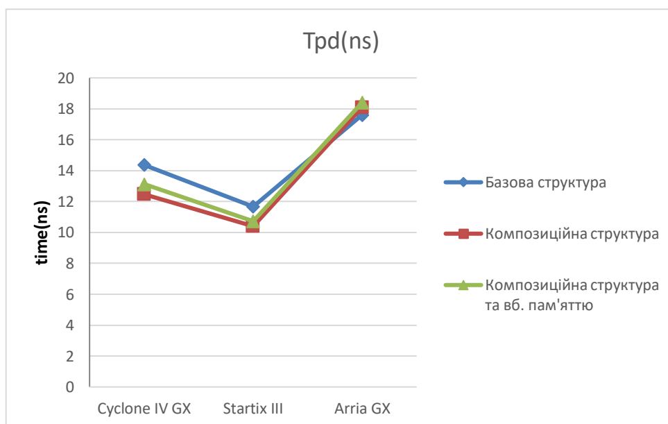
Рисунок 4.8 – Затримка tpd при тестуванні різних структур автомату який працює за першою ГСА на різних мікросхемах
