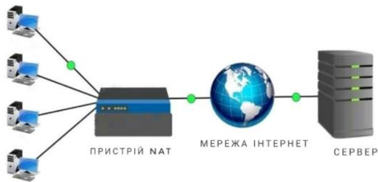
Рисунок 1.2 - Принцип роботи NAT [2]
