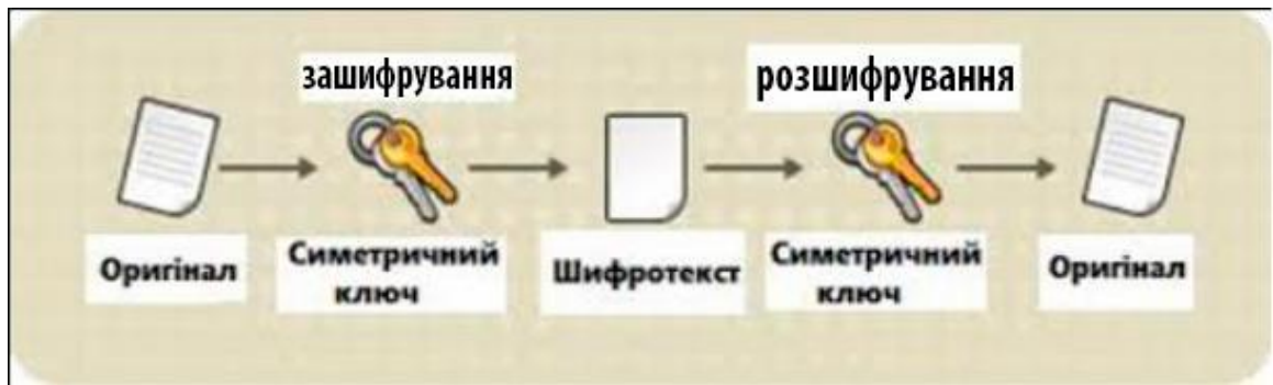
Рисунок 1.6 – Робота симетричної криптосистеми
