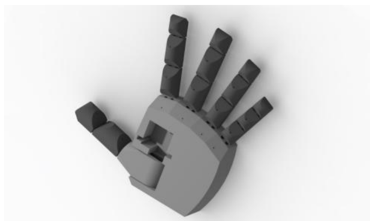
Рисунок 3.9 – Фінальний рендерінг моделі усієї кисті протезу руки
