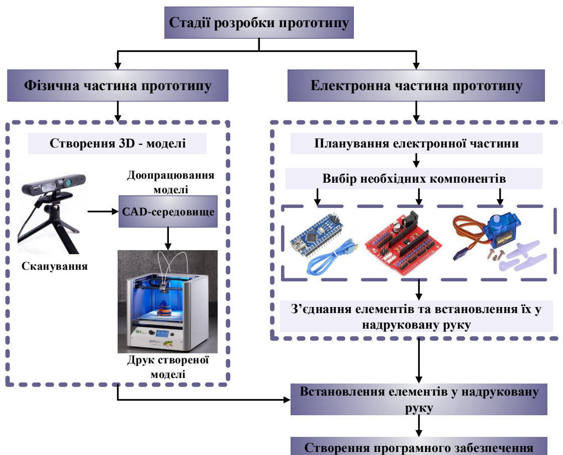
Рисунок 3.1 – Метод комплексного віртуального та фізичного прототипування
