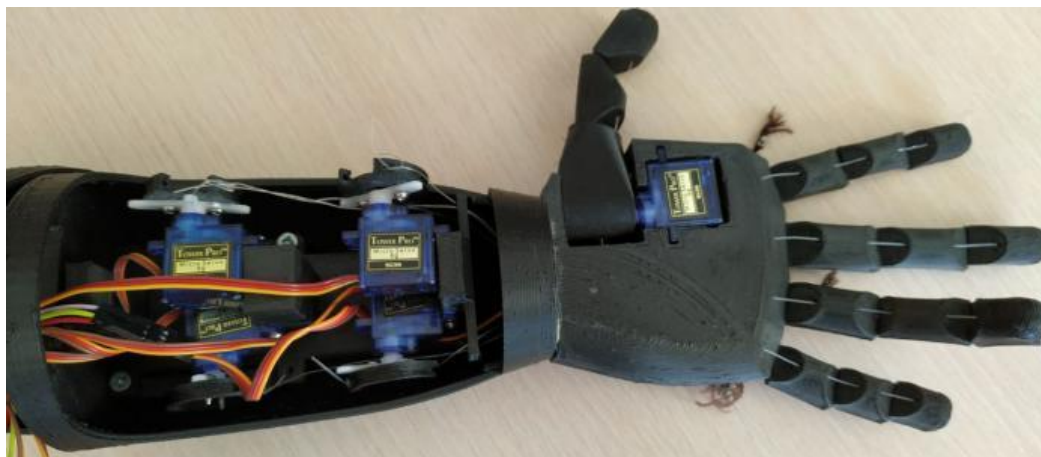
Рисунок 3.29 – Закріплення сервоприводів на механічній частині
