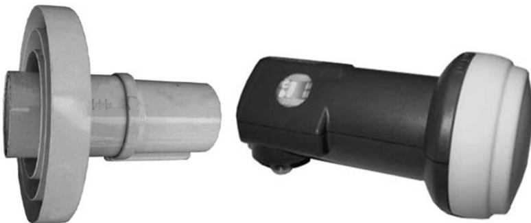
Рисунок 1 - Зовнішній вид НВЧ модуля приймального пристрою СТМ
