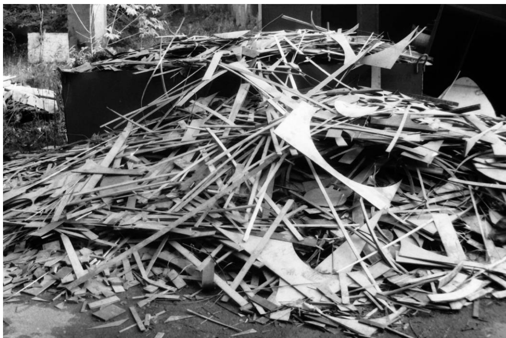
Рисунок 1.1 – Відходи листового обрізу титану BT1-0
