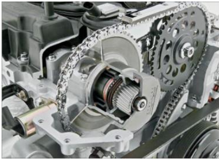
Рисунок 6.10 – Механізм газорозподілу двигуна
