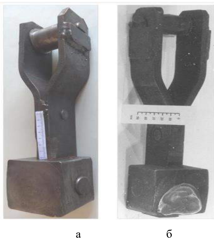
Рис.1.3 – Молоток до експлуатації (а) і після напрацювання 250 \times 10^3 циклів (б)
