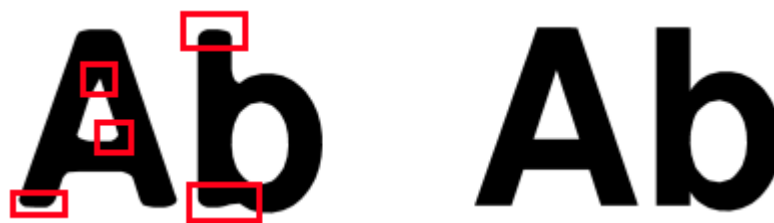
Рисунок 1.8 – Округлені краї гліфів при одноканальному SDF
