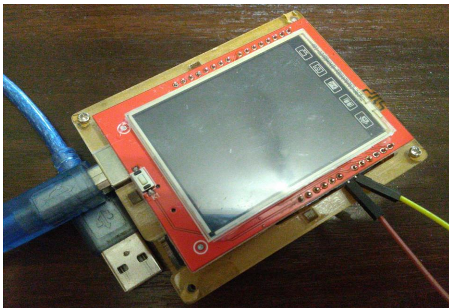
Рисунок 2.2 – Фотографія плати Arduino UNO з модулем дисплею та шнур з'єднання з ПК
