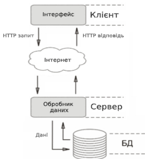
Рисунок 2.1 – Принцип функціонування веб-додатків [7]
