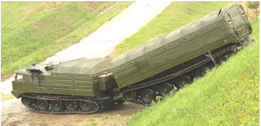
Рисунок Б.9 – Дволанкові гусеничні плаваючі транспортери ДТ-10П, ДТ-20П, ДТ-30П вантажопід'ємністю 10, 20 і 30 тон
