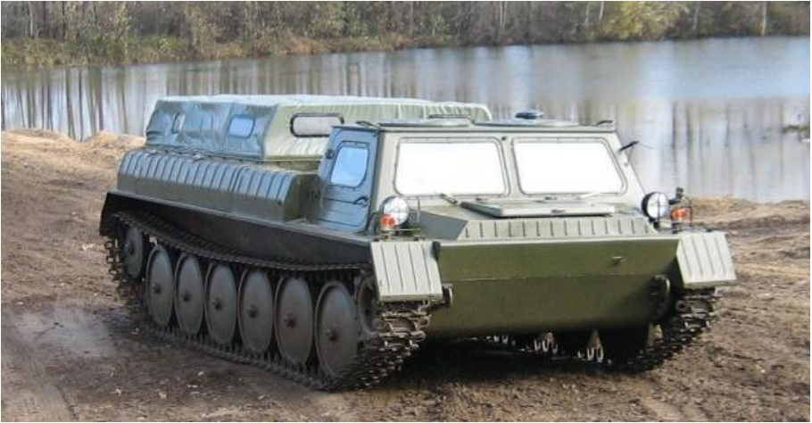
Рисунок Б.3 – ГТ-СМ (ГАЗ-71) - гусеничний транспортер-снігоболотоход модернізований. Випускався з 1968 по 1985 роки на Заволзькому заводі гусеничних тягачів (ЗЗГТ). Базою для створення ГТ-СМ послужив гусеничний транспортер ГТ-С (ГАЗ-47)
