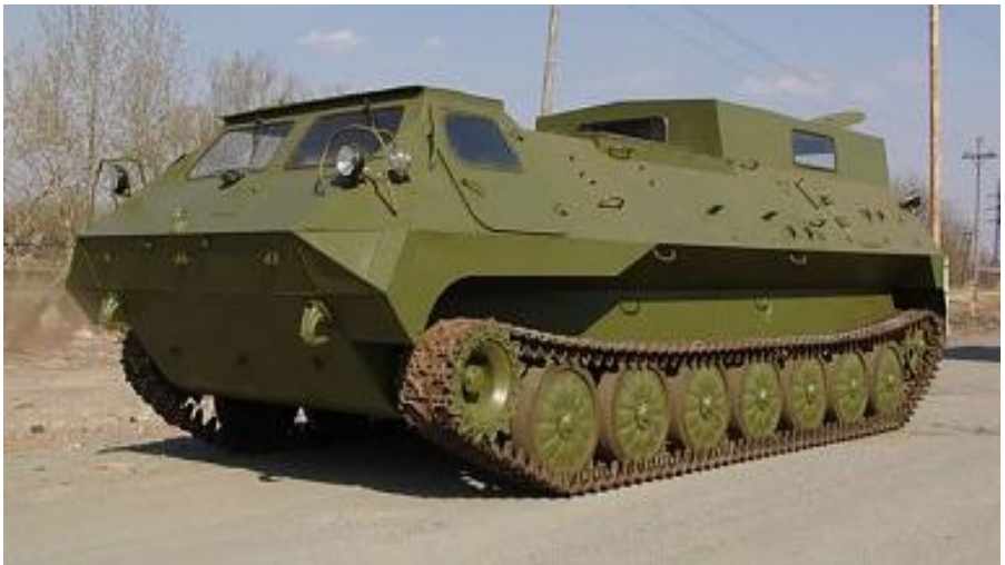
Рисунок Б.11 – МТ-ЛБУ – багатоцільовий тягач легкий броньований з подовженим шасі (У)
