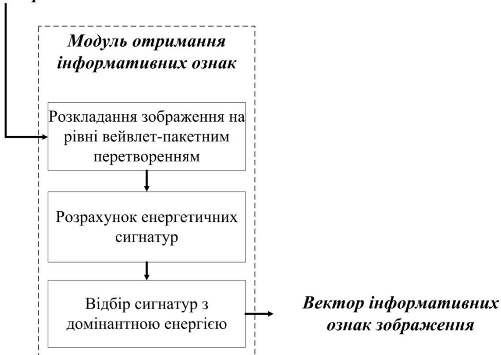
Рисунок 2.3 – Структурна схема модуля отримання інформативних ознак, інваріантних до повороту та зміни масштабу
