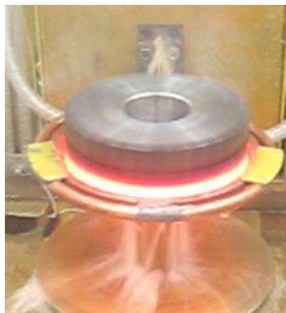
Рисунок 3.2 - Загартування шестерні, що обертається, кільцевим індуктором-спреєром
