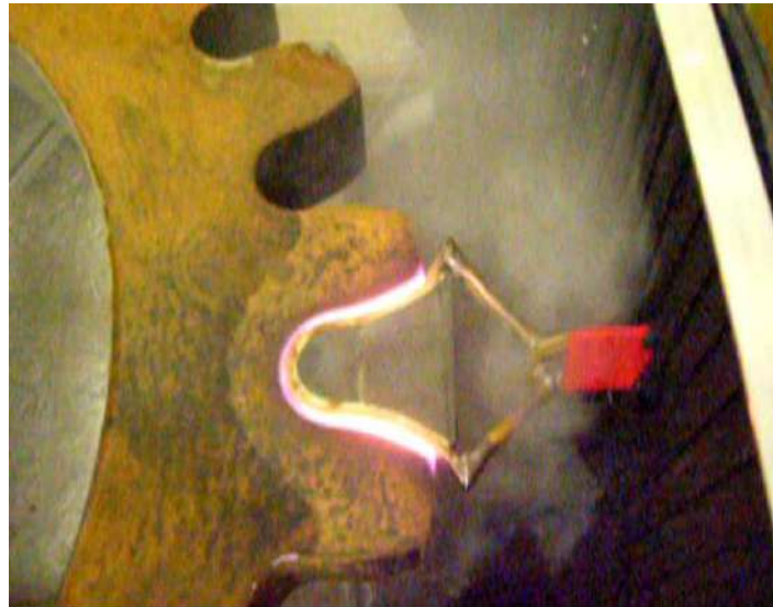
Рисунок 3.3 - Загартування зубчатого колеса по впадині зубів
