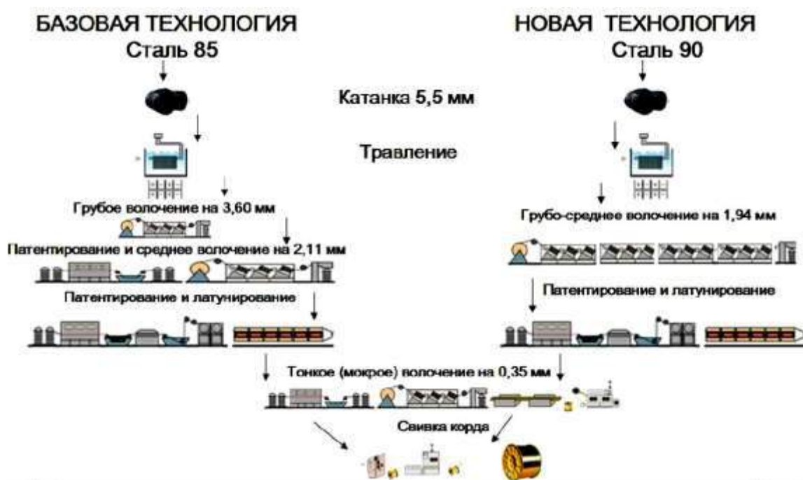
Рисунок 5.19 – Технологическая схема переработки, базовая и новая, термомеханически обработанной высокоуглеродистой стальной катанки на сверхвысокопрочный металлокорд конструкции 3+2×0,35ST.
