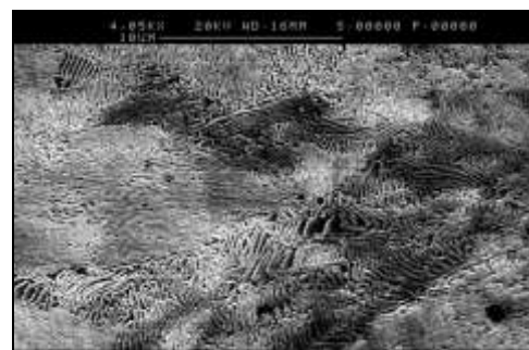
Рисунок 4.14 – Микроструктура стали 90 после аустенитизации и последующего непрерывного охлаждения со скоростью 15^{\circ}\text{C}/\text{с} до 550^{\circ}\text{C} .
