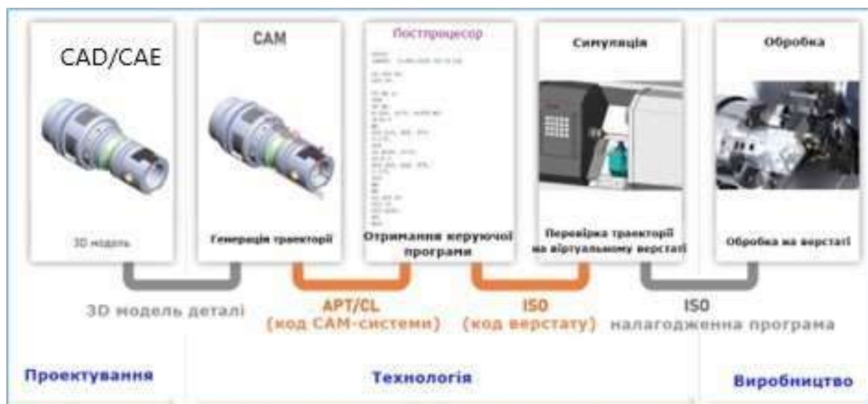
Рисунок 1.2 - Ідеальний ланцюг CAD/CAM/CAE систем для виробництва
