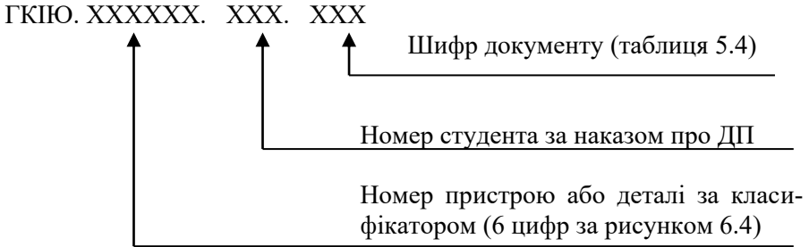
Рисунок 5.3 – Схема позначення креслень
