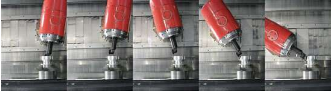
Рисунок 5.14 – Безперервна фінішна обробка з використанням осі В без зміни інструменту [14]
