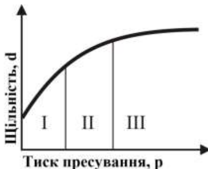
Рисунок 6.7 – Діаграма пресування (ущільнення) порошку.
