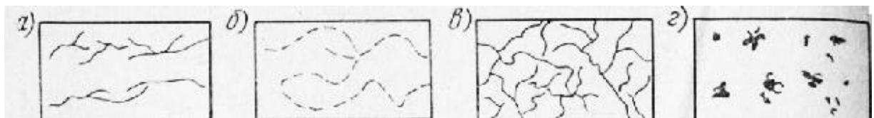
Рисунок 5.4 - Характер дефектів при капілярному методі контролю
