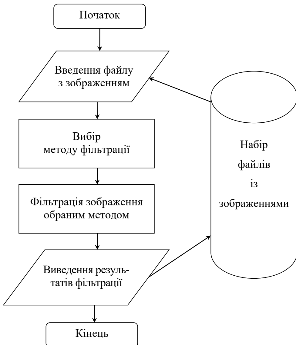
Рисунок 3.2 – Схема функціонування програмного забезпечення для фільтрації зображень
