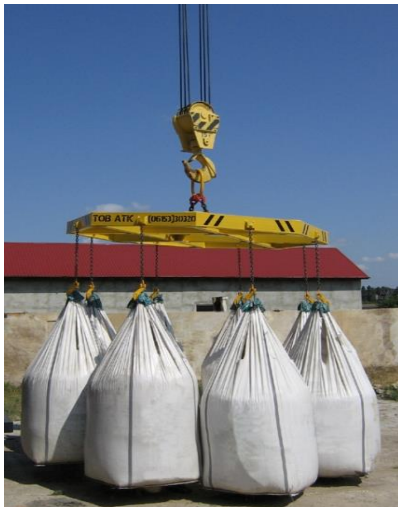
Рисунок 2.1 – Траверсний захват для перевалки сухих будівельних сумішей у big-bag
