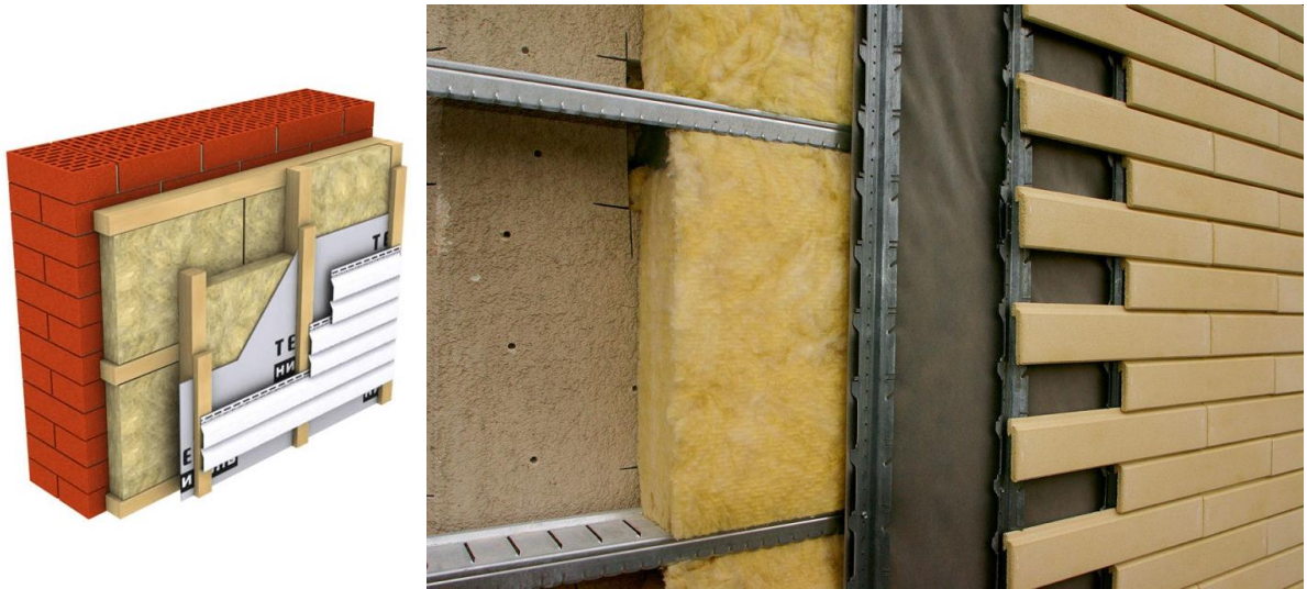
Рисунок 6.27 – Конструкція фасаду з використанням сайдингу
