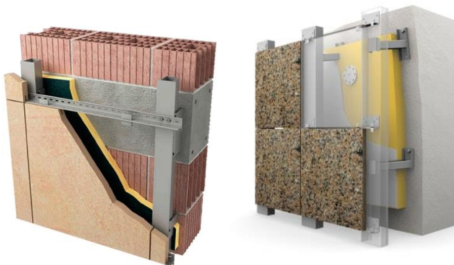
Рисунок 6.25 – Конструкція фасаду з граніту
