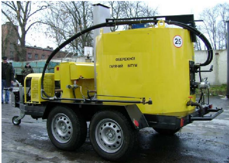
Рисунок 3.48 - Котел бітумний Б-400,1000
