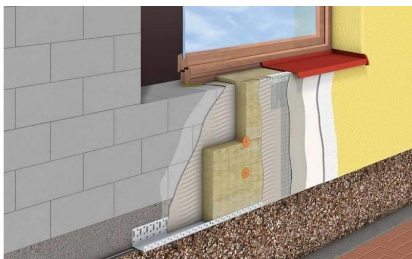
Рисунок 6.7 – Мокрий фасад у розрізі
