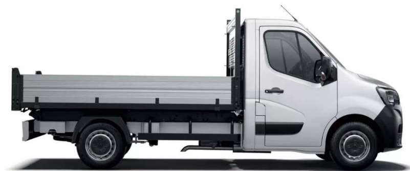
Рисунок 3.45 – Автомобіль бортовий RENAULT Master, вантажопідйомністю до 3,5 т
