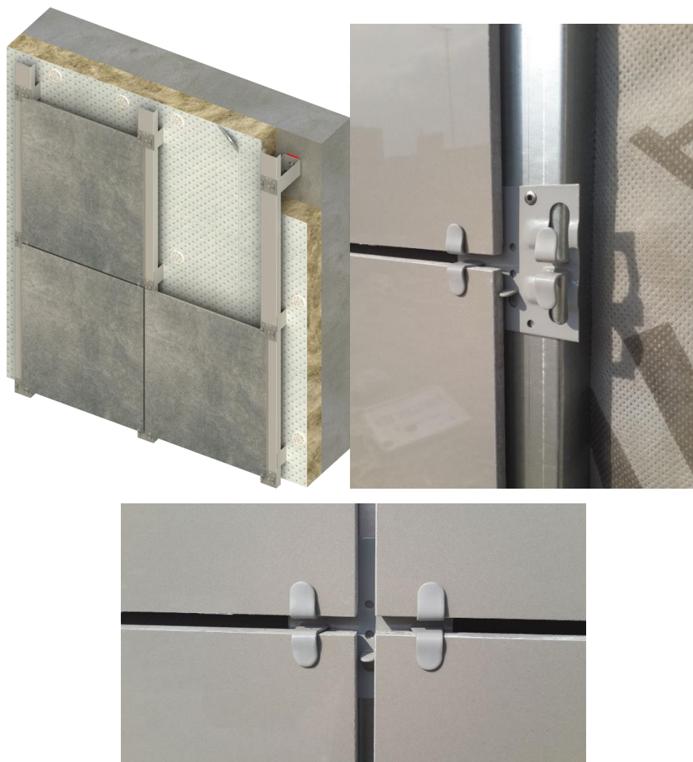
Рисунок 6.18 – Конструкція фасаду з керамогранітними плитами
