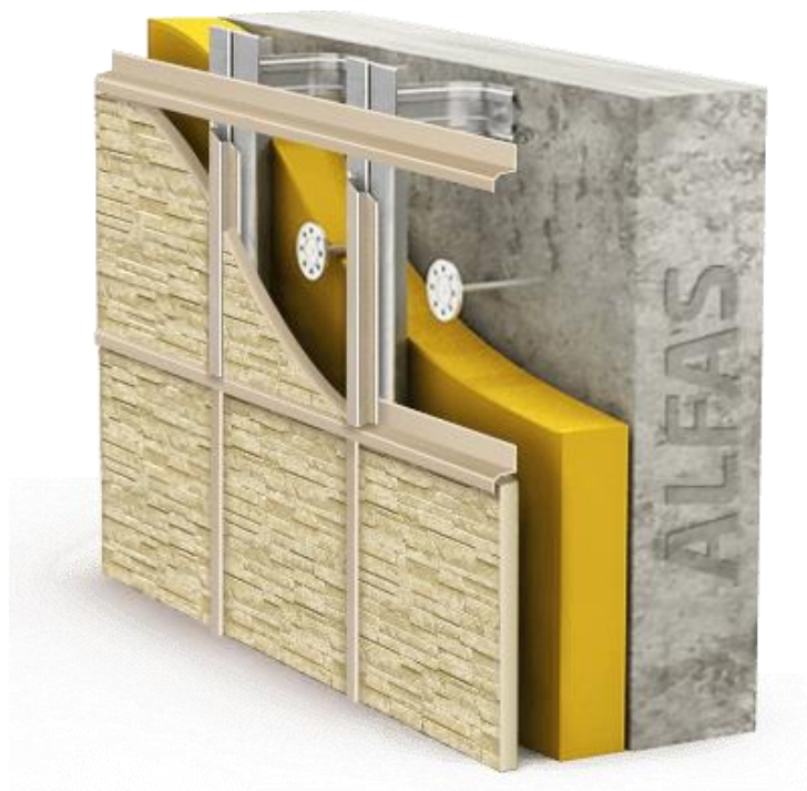
Рисунок 6.17 – Конструкція фасаду з використанням фіброцементних плит
