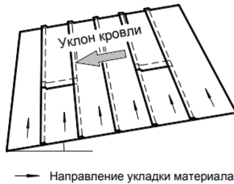
Рисунок 3.15 - Укладання матеріалу на схилі даху перпендикулярно ухилу.
