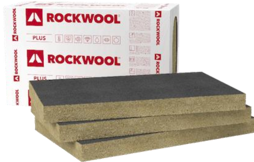
Рисунок 1.23 - Плити з кам'яної вати з обкладкою із склохолста для термоізоляції ROCKWOOL VENTIROCK F PLUS 100/1000/600 30РАС/PAL.
