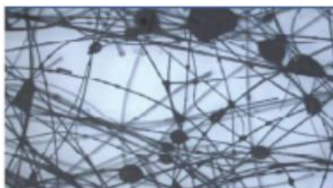
Рисунок 6.47 - Фрагмент волокнистої структури скловолокна
