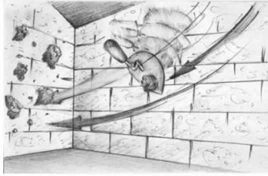
Рисунок 3.26 – Накидання кельмою з нержавіючої сталі з подальшим розрівнюванням
