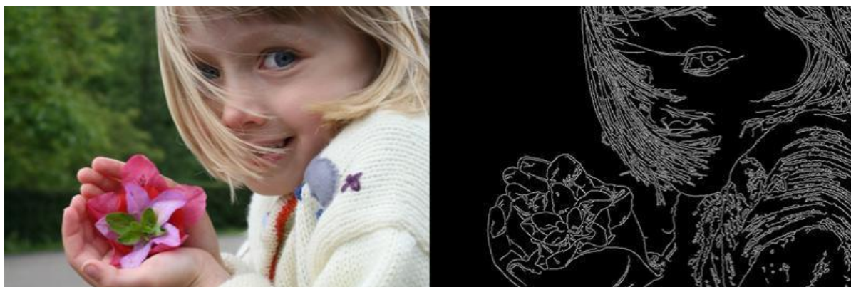
Рисунок 1.6 – Застосування алгоритму Кенні до зображення
