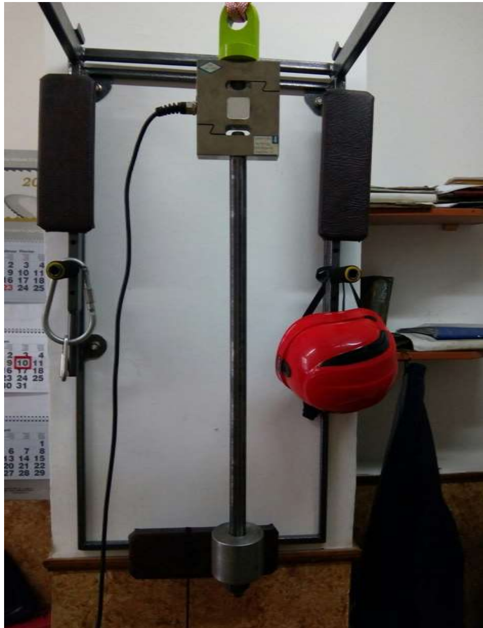
Малюнок 2.1 - Стенд для визначення максимальних навантажень в точках страхування.
