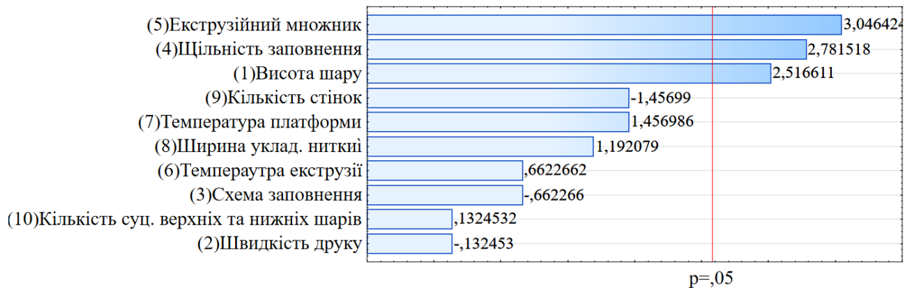
Рисунок 3.40 – Діаграма Парето для моделі впливу параметрів друку на відносне відхилення розміру «с»
