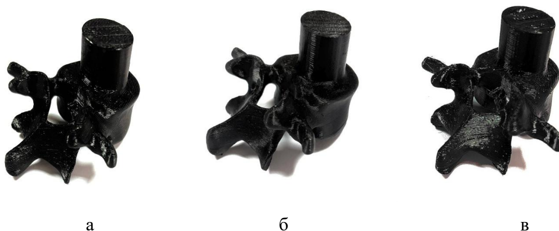
Рисунок 4.2 – Фото надрукованих хребців L4: а – мінімальний час; б – максимальна точність; в – неоптимізовані параметри
