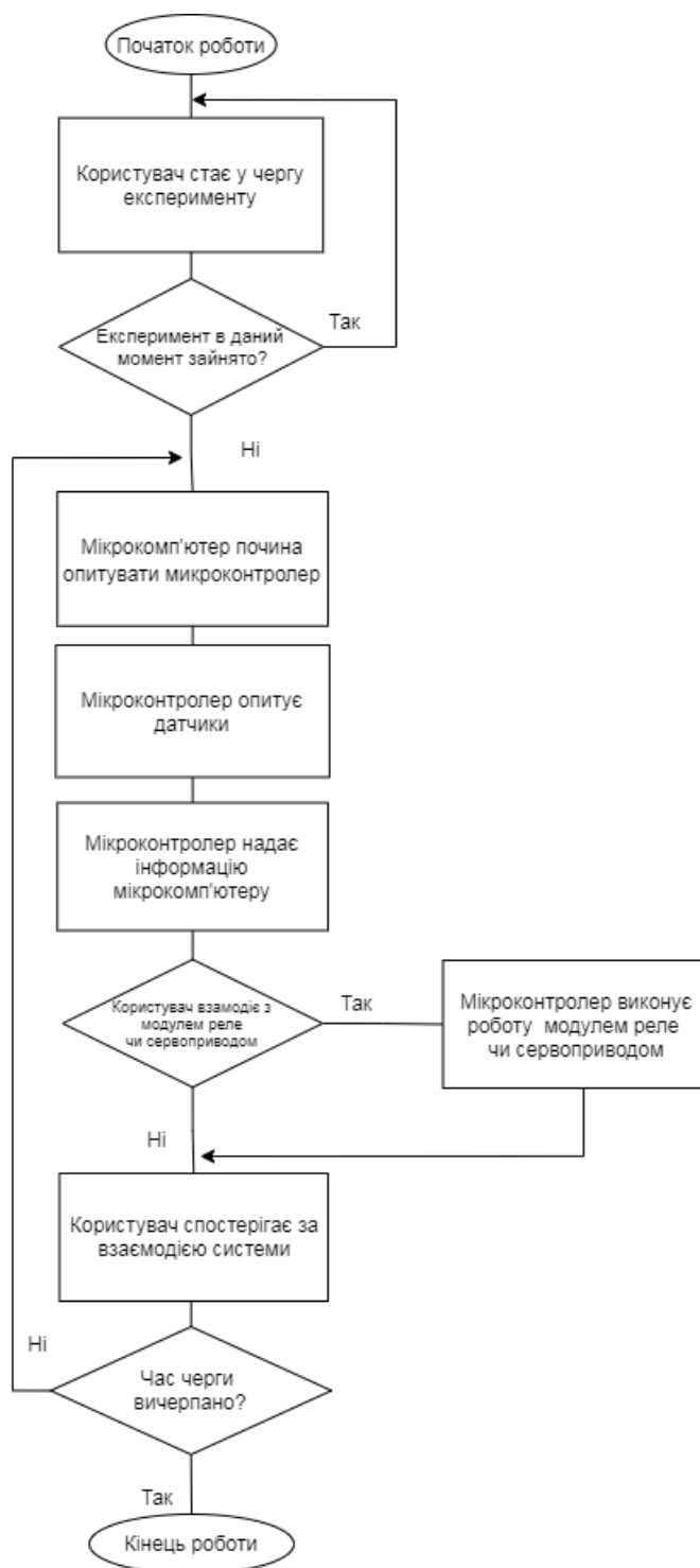
Рисунок 3.2 – Алгоритм функціонування експерименту Розумна теплиця
