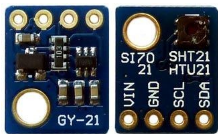
Рисунок 2.8 – Датчик вологості та температури GY-21 HTU21 [33]
