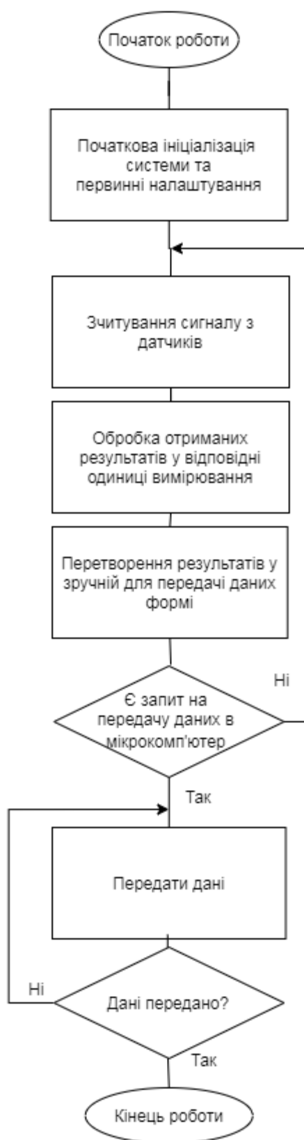
Рисунок 3.10 – Алгоритм роботи програми експерименту Розумна теплиця
