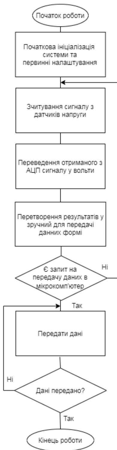
Рисунок 3.8 – Алгоритм роботи програми зчитування показань напруги
