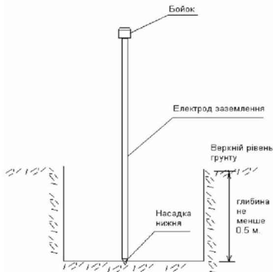
Рисунок 4.7 – Схема монтажу заземлення
