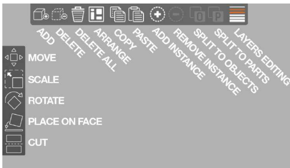
Рисунок 3.22 – Інтерфейс програмного забезпечення для адитивного виробництва «Prusa Slicer 2.1.0» в простому режимі
