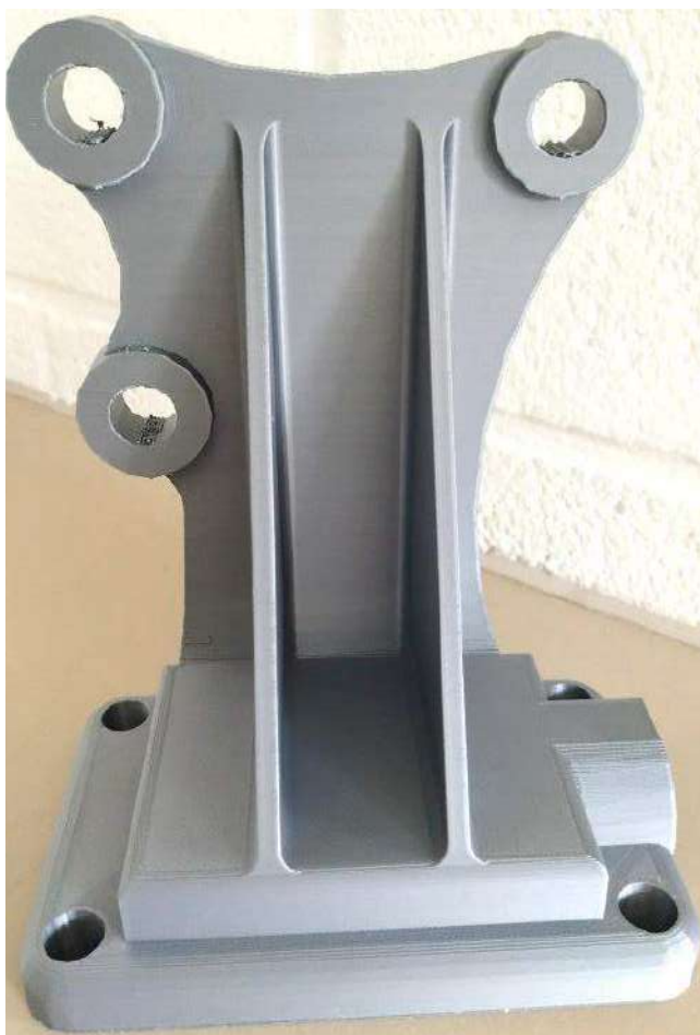
Рисунок 3.26 – Надрукована деталь «кронштейн» в реальному розмірі
