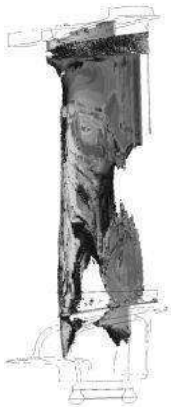
Рисунок 1.6 – Об'єм, що підлягає виключенню з моделі лопатки
