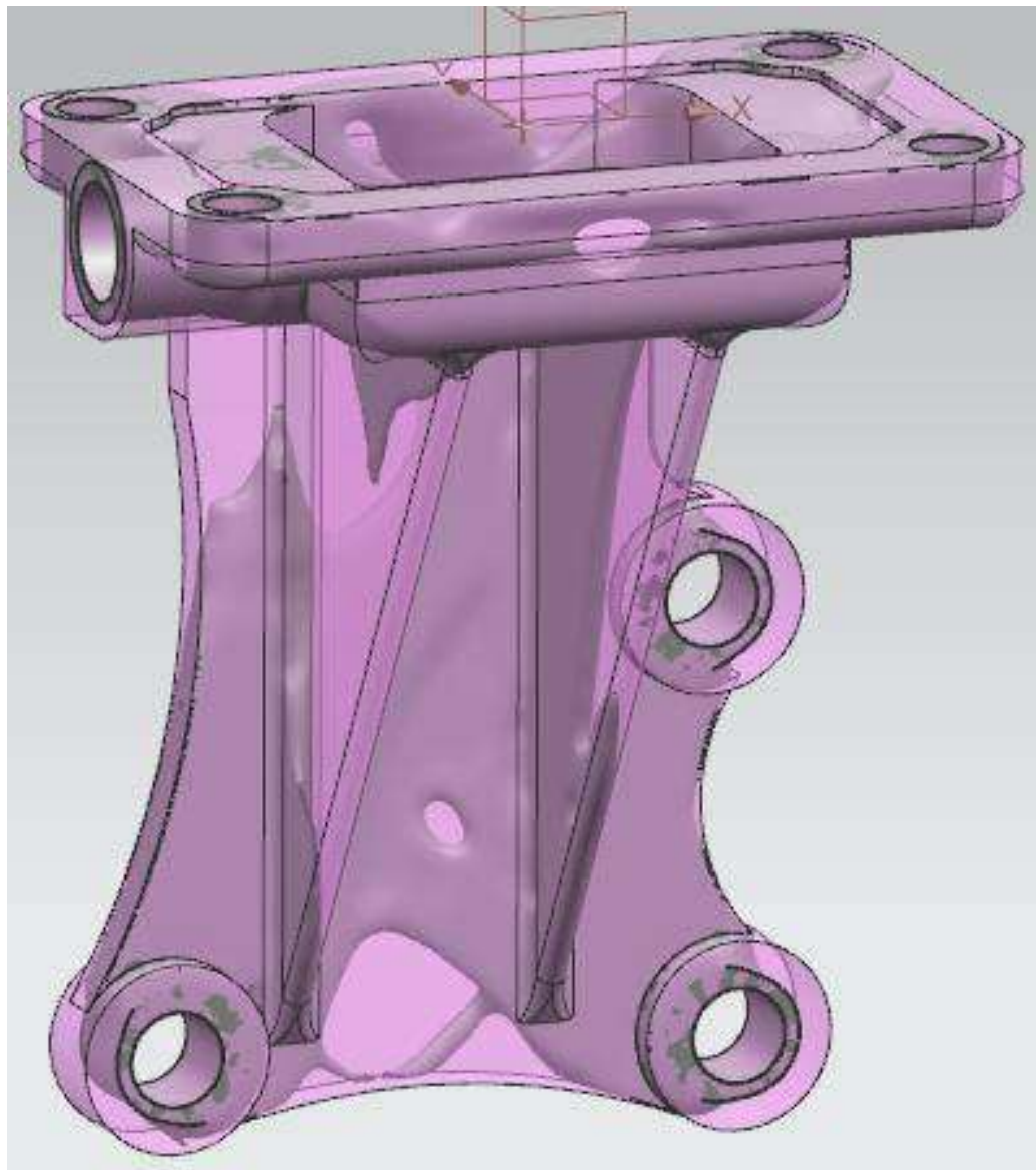
Рисунок 4.4 - 3D модель оптимізованої деталі після другої ітерації
