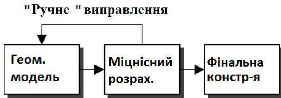
Рисунок 3.1 - Процес проектування без використання оптимізації
