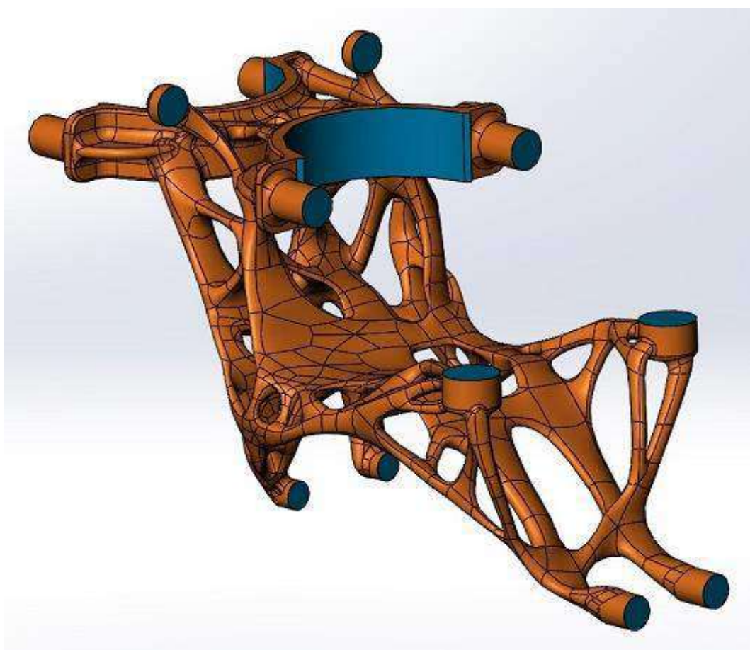
Рисунок 1.9 – Зображення моделі оптимізованої деталі «Кронштейн»
