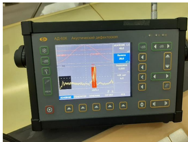
Рисунок 2.3 - Зовнішній вигляд дефектоскопу АД-60К
