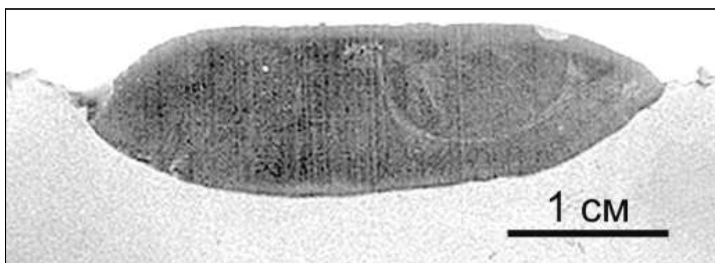
Рисунок 3.9 – Поперечний переріз зразка, наплавленого стрічкою ПЛ АН-111
