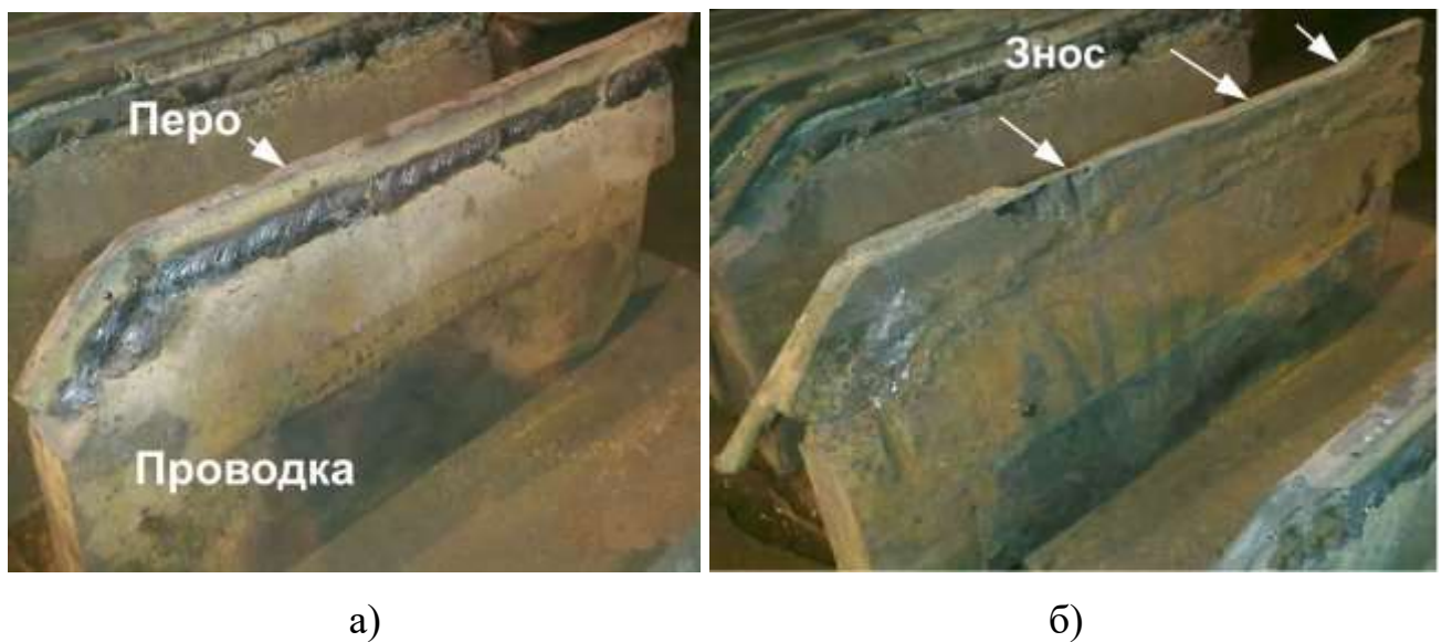
Рисунок 5.39 – Зовнішній вигляд проводки до (а) та після (б) експлуатації.
