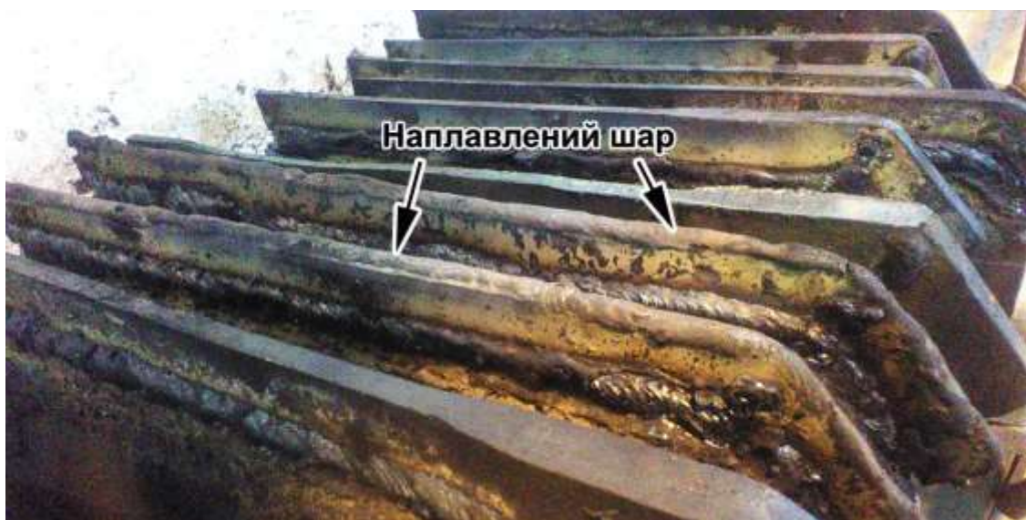
Рисунок 5.40 – Проводки з «пір'ями», наплавленими порошковою стрічкою ПЛ АН-101.
