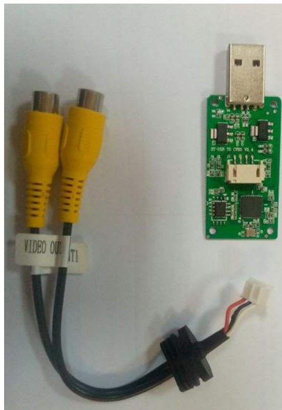
Рисунок 2.11 – Пристрій відео ЦАП на базі MS9123 (друкована плата)
