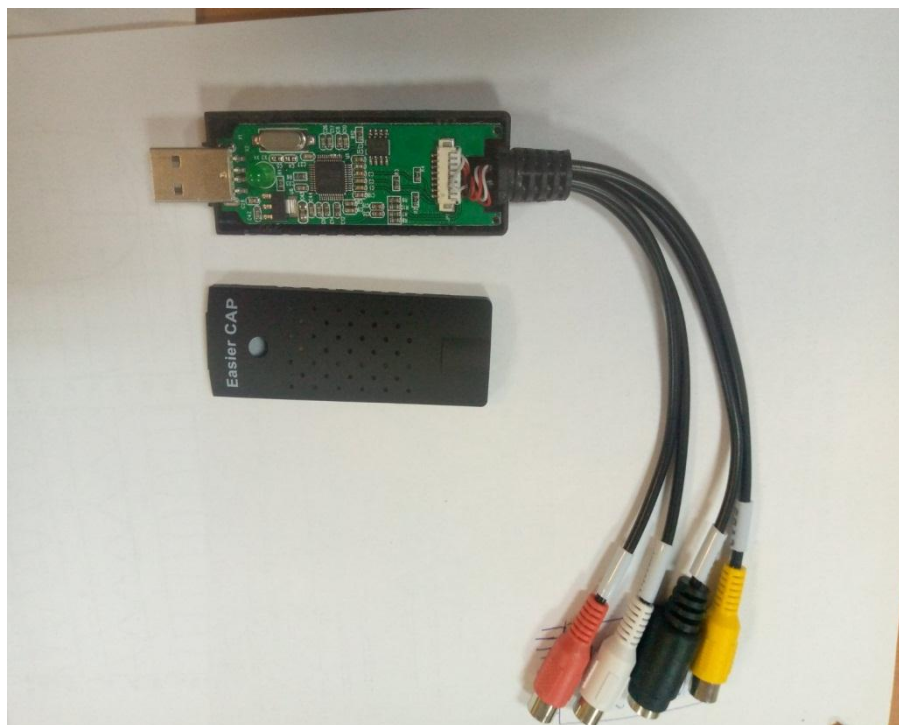
Рисунок 2.7 – Фотографія друкованої плати пристрою перетворення EasyCAP
