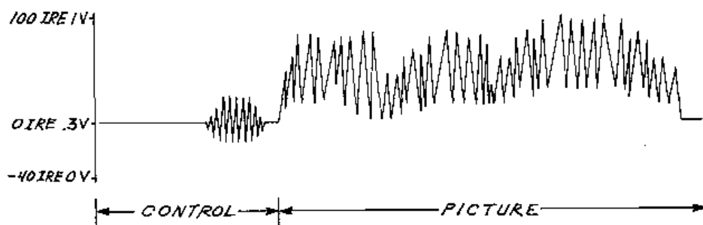
Рисунок 1.8 – Система SSAVI відео з пригніченою горизонтальною синхронізацією та нормальним відео
