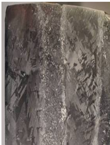
Макро- і мікроструктура зварних швів
