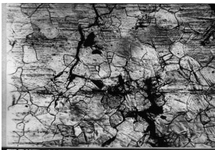
Рисунок 2.2 - Розвиток тріщин по структурним складовим
