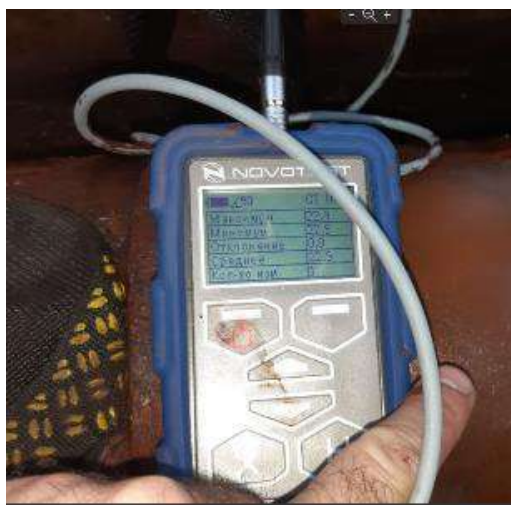
Рисунок 2.5 – Вимірювання твердості ділянки валу, яка була зрізана решіткою печі. Твердість 23HRC
