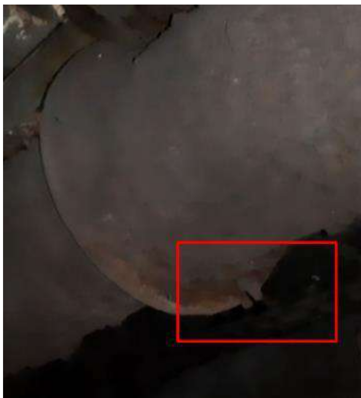
Рисунок 2.3 – Результат пластичного руйнування фланцю валу при недостатній тепловіддачі
