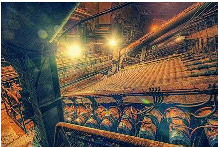
Рисунок 1.4 – Роликовий живильник для завантаження сирих окатишів на випалювальні візки
