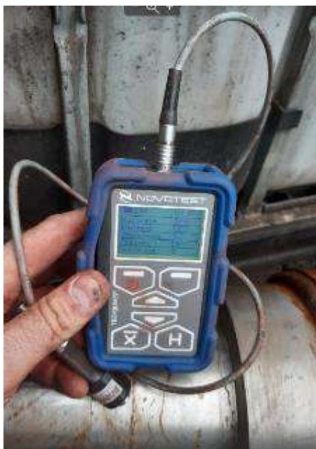
Рисунок 2.6 – Вимірювання твердості нового валу. Твердість 26 HRC
