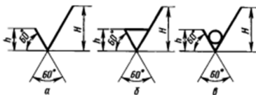
Рисунок 2.2– Знаки для позначення шорсткості
