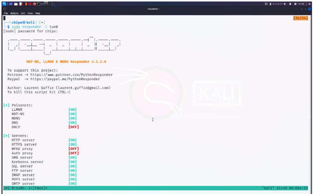
Рисунок 2.3 - Перехоплення трафіку внутрішньої мережі за допомогою Responder
