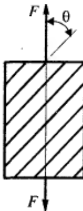
Рисунок 2.21 – Навантаження односпрямованого композиту навантаженням F під кутом \Theta до напрямку волокон
