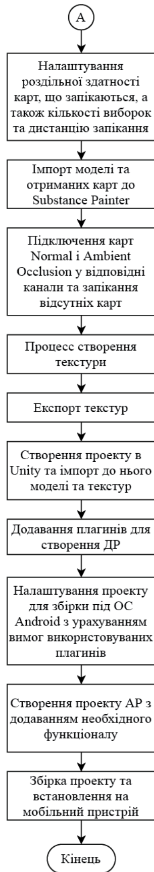
Рисунок А.1 (аркуш 2) – Блок-схема алгоритму побудови 3Д моделі та створення додатку ДР (завершення)
