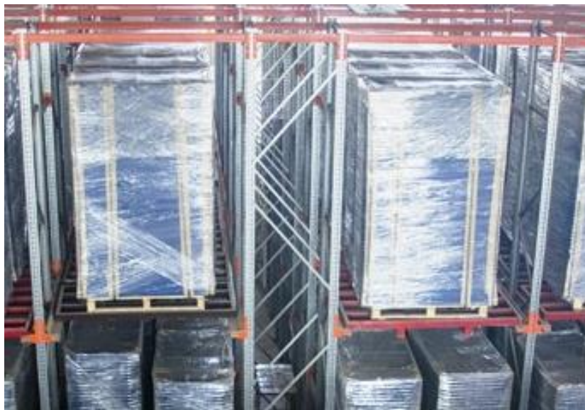
Рисунок 1.8 – Розміщення вантажу у набивному складі
