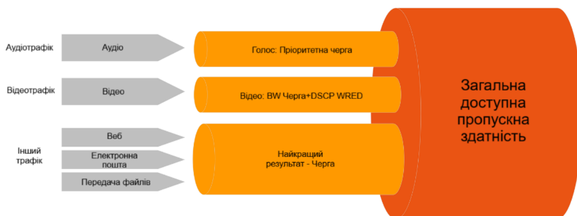
Рисунок 1.7 - Схема прикладу встановлення пріоритетів трафіку
