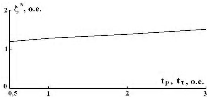
Рисунок 2 – Зависимость оптимального поправочного коэффициента \xi^* от значения времен разгона t_p и торможения t_T двигателя
