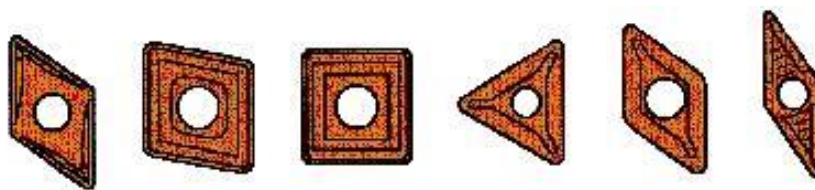
Рисунок 4.7 – Форми багатогранних непереточуваних пластин
