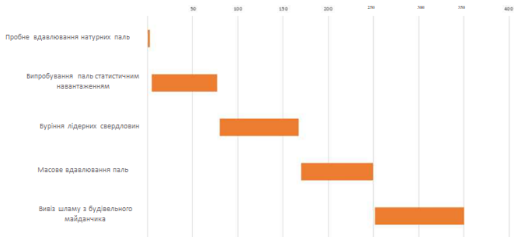
Рисунок 3.10 - МОТЗ на влаштування пальового фундаменту методом вдавлювання
