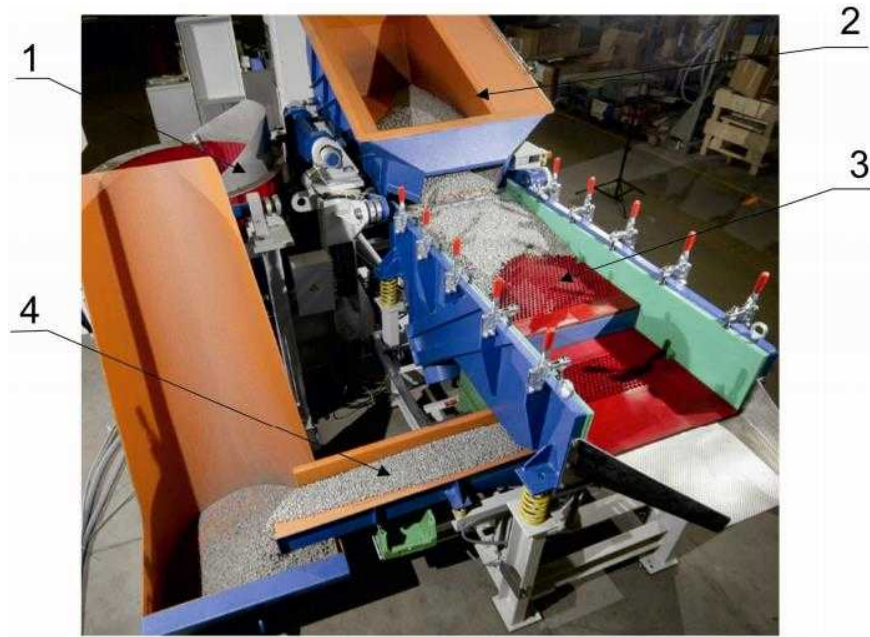
1 – тороїдальна вібраційна технологічна машина; 2 – вібраційний бункерний живильник; 3 – вібросепаратори; 4 – віброкоток Рисунок 4.11 - Комплекс фірми "Walther Trowal" для віброабразивної обробки деталей
