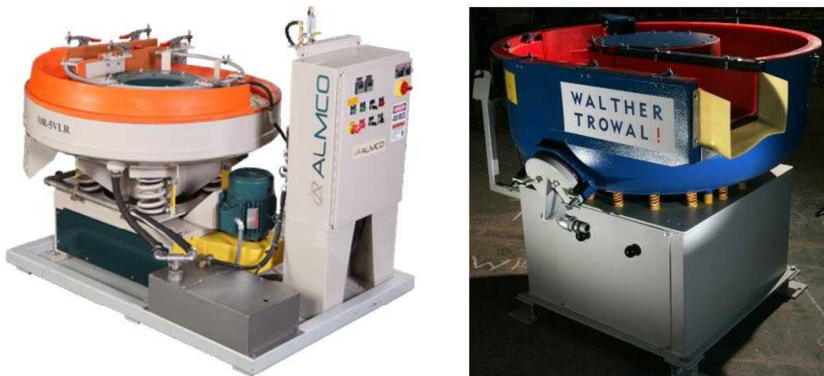
Рисунок 4.15 - Тороїдальні вібромашини фірм ALMCO та WaltherTrowal
