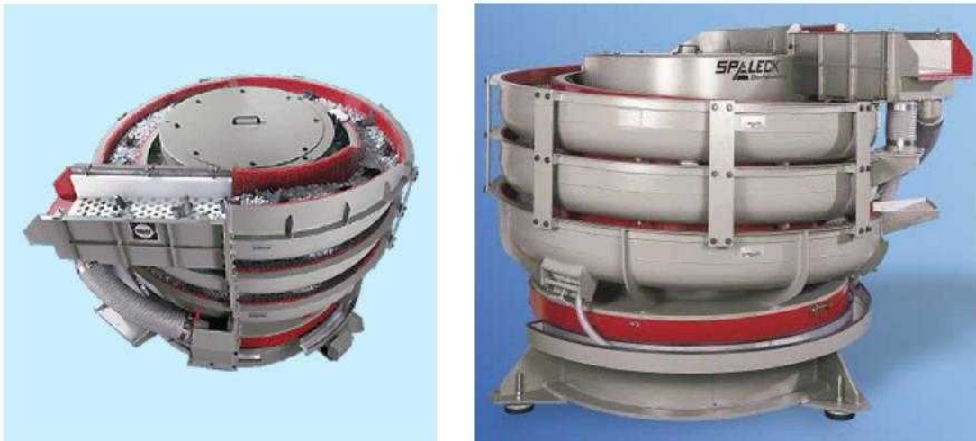
Рисунок 4.14 - Спіратрон фірми SPALECK Oberflächentechnik марка DL 1000 (потужність віброприводу 12.4 кВт, висота 1.9 м, маса 3700 кг)
