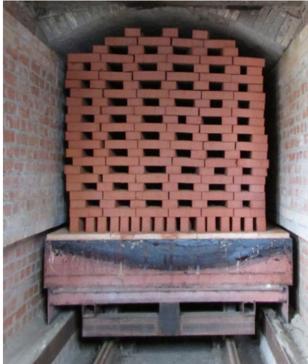
Рисунок 1.1 - Високотемпературна тунельна піч
