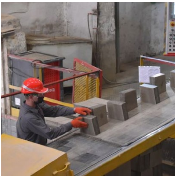
Рисунок 1.2 – Конвеєрна лінія алюмосилікатного цеху
