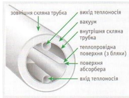
• Рисунок 10 – Переріз трубопроводу колектора
