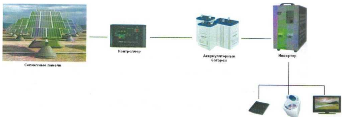
• Рисунок 11 – Фотоелектричне перетворення з використанням напівпровідникових фотоелектричних перетворювачів
