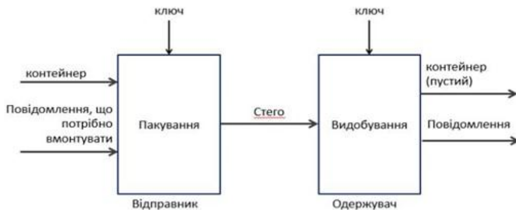
Рисунок 2.2 – Структура стеганосистеми: основні компоненти та принципи взаємодії
