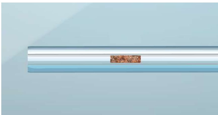
Рисунок 4.6 – Повна корозія стенту
