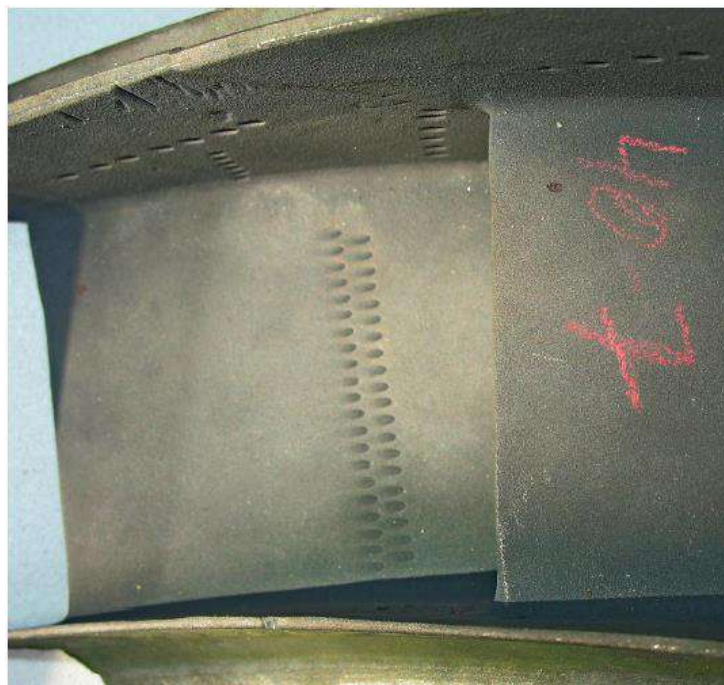
Рисунок 3.2 – Зовнішній вигляд лопаток сектора №1 з боку спинки до віброполірування.
