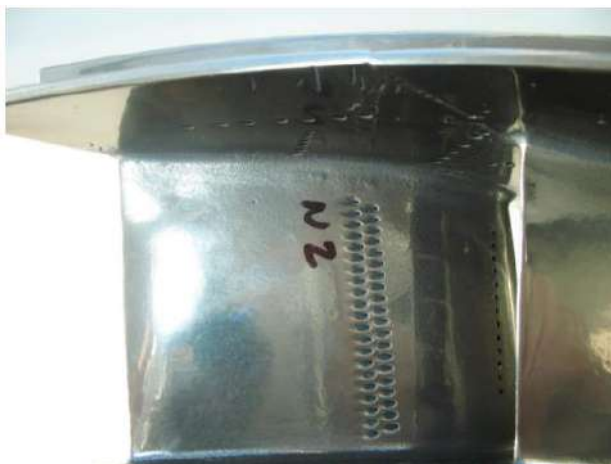
Рисунок 3.3 – Зовнішній вигляд лопаток сектора №1 з боку спинки після віброполірування.
