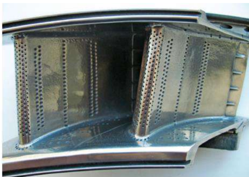
Рисунок 3.5 – Зовнішній вигляд лопаток сектора №1 з боку "корита" після віброполірування.
