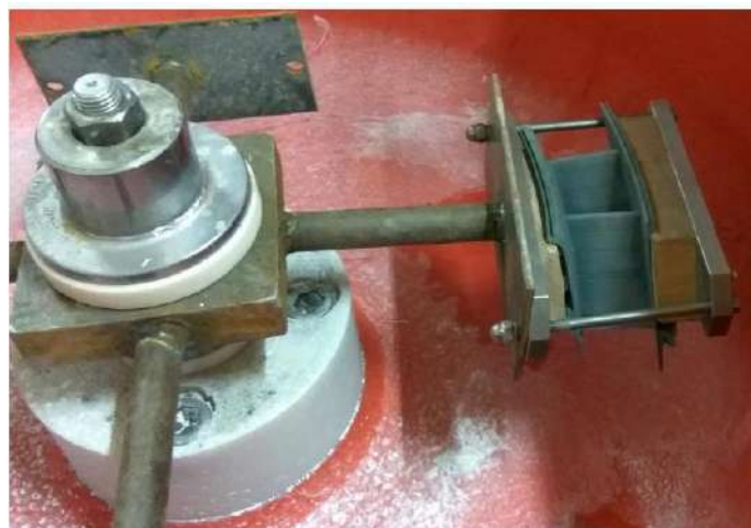
Рисунок 2.2 – Сектор лопаток, закріплений в зоні обробки деталей
