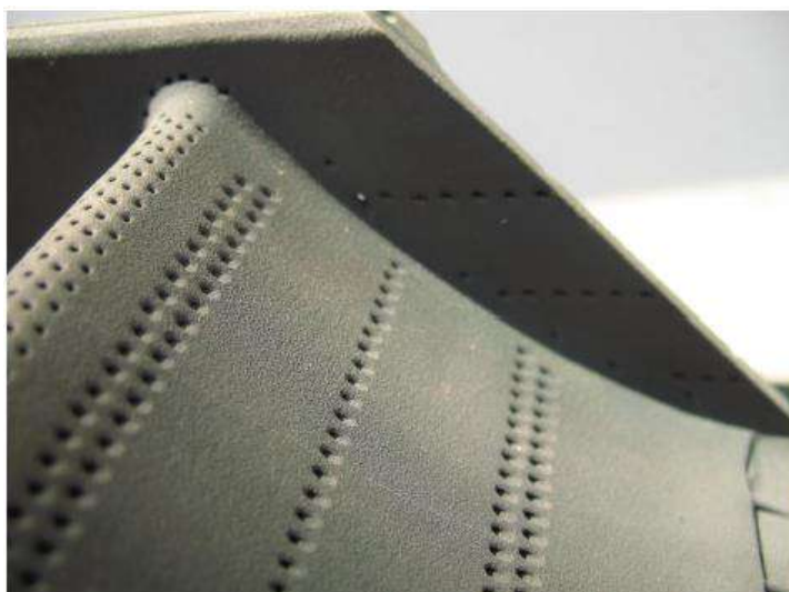
Рисунок 3.6 – Лопатка №2 сектора №1 зі сторони «корита» до обробки.
