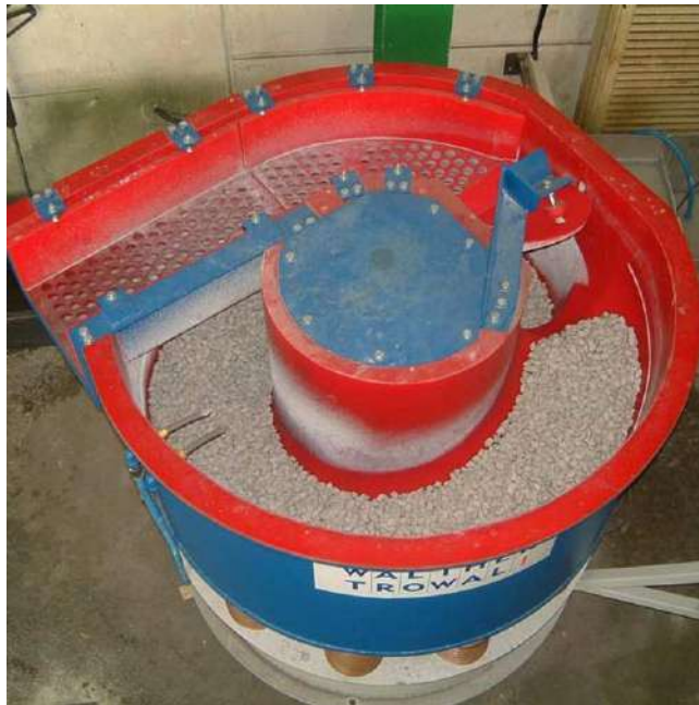
Рисунок 1.26 – Віброустановки з вертикальним валом вібратора та спіральним напіввідкритим контейнером
