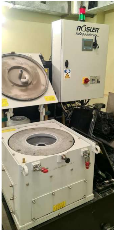
Рисунок 2.5 – Промивочна установка фірми RÖSLER
