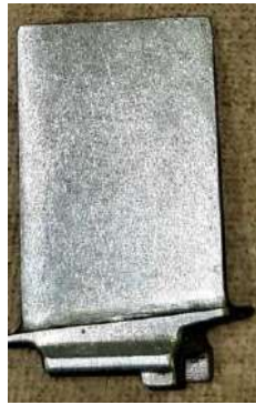
Рисунок 2.2 – Лопатка компресора високого тиску авіаційного ГТД
