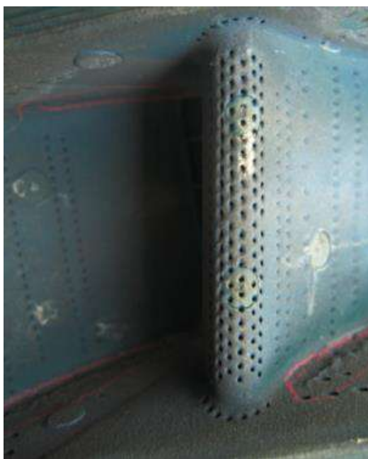
Рисунок 3.11 – Проточна поверхня сектора №2 по внутрішній бандажній полиці до віброполірування.
