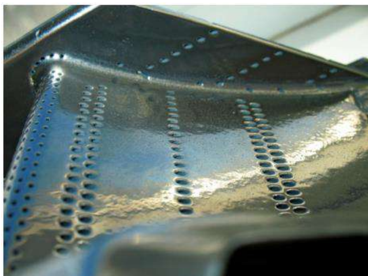
Рисунок 3.7 – Лопатка №2 сектора №1 зі сторони «корита» після обробки.
