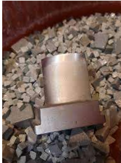
Рисунок 2.4 – Загальний вигляд лопаток КВТ у віброполірувальній установці перед обробкою
